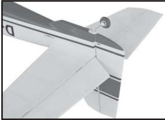
Ruderhebel Seitenruder Control horn of Rudder.
