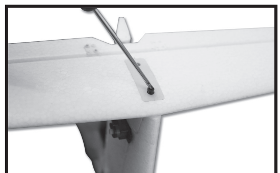
6. Verbinden Sie das Höhenruder mit dem Ruder und schrauben Sie es fest.
