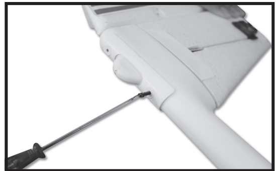
4. Stecken Sie das Ruder auf den Rumpf und schrauben Sie es fest.
