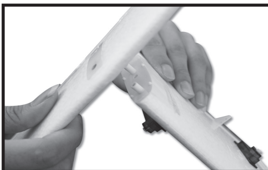
6. Verbinden Sie das Höhenruder mit dem Ruder und schrauben Sie es fest.
