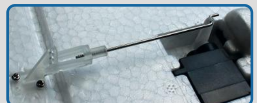
Fertig montierte Anlenkung
